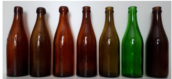
Utvecklingen av Sveriges första pantflaska över 130 år. De två vänstra flaskorna blåstes för hand (1880-talet, 1901) och de tre flaskorna längst till vänster (1880-talet, 1901, 1930) korkades. Övriga flaskor (1937, 1959, 1968, 2013) maskinblåstes och kapsylerades. Bilden används med tillstånd från Per Henriksson.
